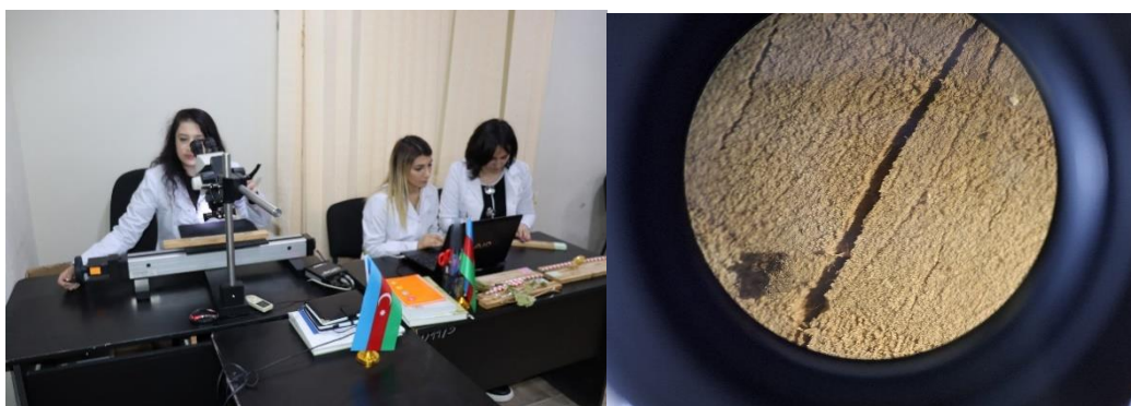
Şəkil 2. Nümunələrin LİNTAB6 qurğusu ilə hesablanması, mikroskop altında görünüşü
